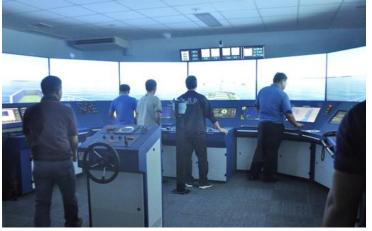
ブリッジ・シミュレーター・トレーニングは、甲板部の職員・部員を対象にした世界の主要な港や船舶交通の激しい水路等の異なった海域における実際の当直場面を再現したトレーニングです。Bulk Carrierや Tanker等船種ごとに設定変更をしたり、曇天・雨天等の異なる海象条件も再現できます。航海当直中の船橋では、役職に応じた判断を求められます。狭水路通航や交通量の多い航路入り口付近のシナリオを策定し、円滑なコミュニケーションが図られているかを繰り返し確認し合います。また、トレーニングの効果を最大限発揮させるために、少人数で行うことを原則とし、より実運航時に近い状況を再現し緊張感を持たせて実施しております。
